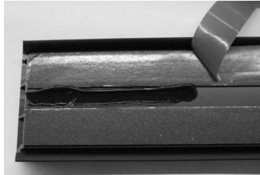
3. Schutzfolie an beiden Enden ca. 5cm abziehen. Zusätzlich zwischen den Klebestreifen an beiden Enden ca. 10cm langen alterungsstabilen Klebstoff verteilen.
